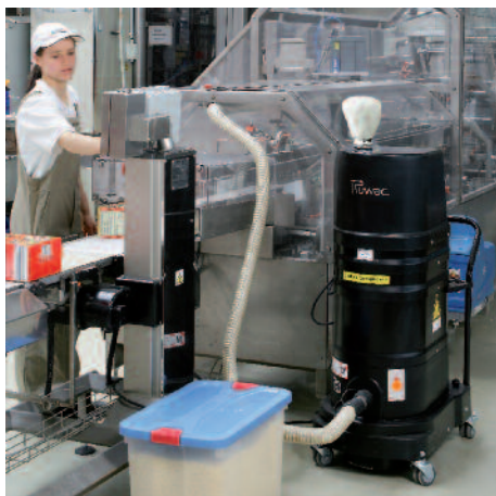
DS 1220 FS (сбор мелкодис- персной пыли) для зон со взрывоопасной пылью на предприятии пищевой промышленности
