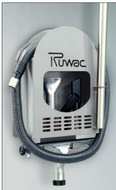
Держатель для шланга и аксессуаров, листовая сталь, цвет RAL 7035 (серый), монтаж на стене, Д — 540 мм, Ш — 252 мм, В — 735 мм для аксессуаров Ø 50 мм, для шланга прим. 10,0 м Арт. №: 52886 (поставка без аксессуаров)
